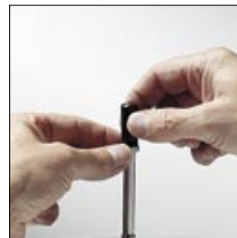
2) Sonde während des Abschraubens der Kapsel festhalten.
