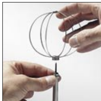
5) Sonde während des Aufschraubens des Sensor-Drahtschutzes festhalten.
